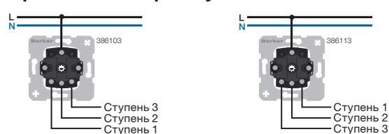
**Рис 1:** Трехступенчатый выключатель с нулевым положением [№ для заказа 3861 03] / трехступенчатый выключатель без нулевого положения [№ для заказа 3861 13]
