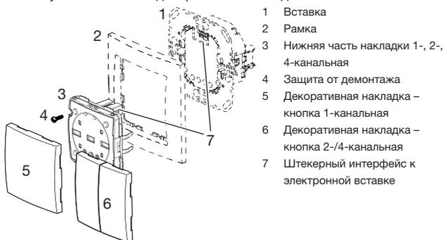
Рис 1: Монтаж на примере радиوشины KNX
