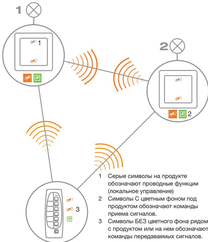
Рис 3: Пример конфигурации передатчик/приемник
