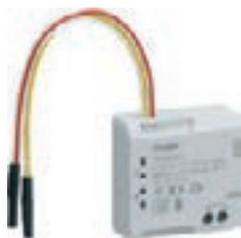
**Переключающее исполнительное устройство 1-канальное и бинарный вход 2-канальный, радиошина KNX, 230 Вт, 4А, (2 провода), для скрытого монтажа**
