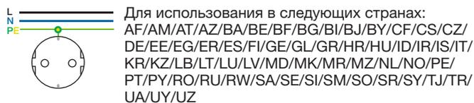
**Рис 1:** Розетка SCHUKO\* с 2 полюсами + заземление, 250 В~, 16 А
