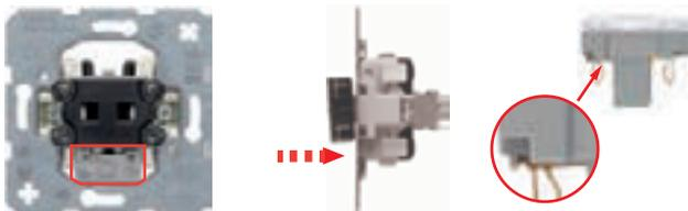
Элемент подсветки устанавливается или заменяется с фронтальной стороны (нет необходимости демонтировать выключатель). В зависимости от применения может понадобиться удалить язычок контакта (см. рис. справа)
