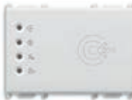
14457 Устройство чтения карт-транспондеров для установки вне помещения, стандарт KNX, 2 релейных нормально разомкнутых выхода 4 А 24 В~, 2 входа, 12-24 В~ 50/60 Гц и 12-24 В пост. тока (SELV), - 3 модуля. Поставляется без карты-транспондера. Глубина: 36 мм 14457.TR Как выше, в тропическом исполнении
