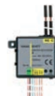
01477 Модуль с 2 цифровыми входами, программируемыми для контактов, не имеющих потенциала, 1 релейный выход для управления с НР контактом для управления освещением 10 А 120-230 В~ 50/60 Гц, 2 выхода для управления светодиодными лампами, система домашней автоматике Ву-ме, установка встраиванием (контакты с задней стороны)
