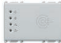
14457.SL Устройство чтения карт-транспондеров для установки вне помещения, стандарт KNX, 2 релейных нормально разомкнутых выхода 4 А 24 В~, 2 входа, 12-24 В~ 50/60 Гц и 12-24 В пост. тока (SELV), - 3 модуля. Поставляется без карты-транспондера. Глубина: 36 мм 14457.TR.SL Как выше, в тропическом исполнении
