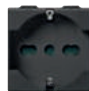
09210.CM 16 А, с заслонками - 2 модуля. Глубина: 26,4 мм
