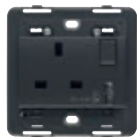
■ 20223.A SICURY 2P+E 13 A 250 В~ с выключателем 2P и выходом USB типа А. Глубина: 21 мм
