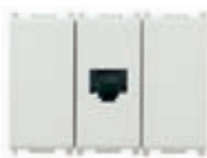
14505.AB Релейный модуль с гнездом RJ45 для пульта 2 свет + 2 AUX, подключение к модулю 8IN/8OUT или дисплей Call-way, 4 релейных выхода 24 V NO, антибактериальная обработка - 3 модуля. Глубина: 29,5 мм
