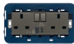
■ 19224.AC.M SICURY 2P+E 13 A 250 В~ с двумя выключателями 2P, выходом USB типа A и выходом USB типа C. Глубина: 21 мм
