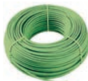
01890.C Кабель для системы KNX, 2x2x0,8 мм, с оболочкой LSZH, класс CPR Cca s1b d1 a1, следовательно, пригодный для укладки в одном коробе с кабелями I категории (U0 = 400 V), зеленый - 100 м
