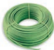
01890.E Кабель для системы KNX, 2x2x0,8 мм, с оболочкой LSZH, класс CPR Eca, следовательно, пригодный для укладки в одном коробе с кабелями I категории (U0 = 400 V), зеленый - 100 м
