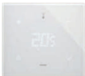
21514.F70 Термостат с сенсорным экраном (отопление и кондиционирование воздуха), 3-скоростное и пропорциональное управление FAN-COIL, управление ВКЛ/ВЫКЛ (класс I, доля 1%), ШИМ, ПИД-регулятор (класс IV, доля 2%), может быть сопряжен с приводом 01466.1 для модулирующего комнатного термостата (класс V, доля 3%), 1 вход для датчика 20432, 19432 или 14432 или проводного датчика 02965.1, 1 программируемый цифровой вход, светодиодная RGB-подсветка, Белый бриллиант - 2 модуля. Глубина: 30,2 мм
