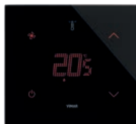
21514.F76 Термостат с сенсорным экраном (отопление и кондиционирование воздуха), 3-скоростное и пропорциональное управление FAN-COIL, управление ВКЛ/ВЫКЛ (класс I, доля 1%), ШИМ, ПИД-регулятор (класс IV, доля 2%), может быть сопряжен с приводом 01466.1 для модулирующего комнатного термостата (класс V, доля 3%), 1 вход для датчика 20432, 19432 или 14432 или проводного датчика 02965.1, 1 программируемый цифровой вход, светодиодная RGB-подсветка, Черный бриллиант - 2 модуля. Глубина: 30,2 мм
