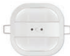
01529.1 Сенсор с инфракрасным датчиком присутствия с углом 360° для включения и выключения освещения в зависимости от уровня освещенности и/или движения, регулируемый диапазон яркости 1-1000 лк, стандарт KNX, потолочная установка. Размеры: 91x91x45 мм
