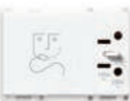
14290.AB Розетка для электробритв с изолирующим транс- форматором 20 ВА, выход 230 В~ и 120 В~ - 3 модуля. Глубина: 41 мм
