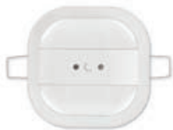
01527 Сенсор с инфракрасным датчиком присутствия с углом 360°, для включения, выключения и постоянной регулировки уровня освещения, отопления, искусственного климата, вентиляции в зависимости от уровня освещенности и/или движения, регулируемый диапазон яркости 1-1000 лк, стандарт KNX, потолочная установка. Размеры: 80x80x45 мм
