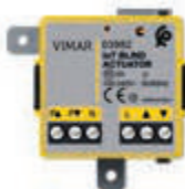
03982 Устройство управления для 1 жалюзи с поворотными ламелями с релейным выходом с перекидными контактами для электродвигателя с cosφ 0,6 2 А 100-240 В~ 50/60 Гц, дистанционное управление, беспроводная технология Bluetooth® 5.0 для систем с mesh-топологией View Wireless и Zigbee 3.0
