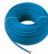
01840.E.B Кабель для Звукового вещание, 2x0,50 мм 2 с оболочкой LSZH, класс CPR Eca, пригодный для укладки в одном коробе с кабелями I категории (U 0 = 400 V), синий цвет - 100 м
