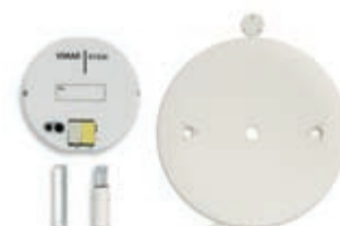
01530 Светочувствительный датчик для регулятора 01528, стандарт KNX, потолочная установка. Размеры: 52,3x54,3x19,3 мм
