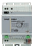
01500.2 Блок питания с выходной шиной 30 В пост. тока 320 мА, питание 120-240 В~ 50/60 Гц, с катушкой расщепления, стандарт KNX, 4 модуля x 17,5 мм
