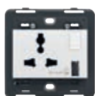
■ 20266.A.B SICURY 2P+E 13 A 250 В~ multistandard с выключателем 2P и выходом USB типа А. Глубина: 21 мм
