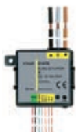
01476 Модуль с 2 цифровыми входами, программируемыми для контактов, не имеющих потенциала, 1 выход для управления жалюзи с релейной ориентацией ламелей для двигателей с соф 0,6 2 А 120-230 В~, 2 выхода для управления светодиодными лампами, система домашней автоматике Ву-ме, установка встраиванием (контакты с задней стороны)
