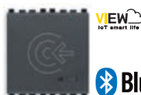
20462 Наружный считыватель смарт-карт NFC/RFID, конфигурация карты с использованием технологии App View Wireless стандарта Bluetooth, технология IoT на основе технологии беспроводной связи Bluetooth® стандарта 5.0 для создания Mesh-системы View Wireless, 1 релейный выход НО 16 А 100-240 В ~ 50/60 Гц, 1 вход DND, светодиод с регулировкой интенсивности, питание 100-240 В ~ 50/60 Гц - 2 модуля. Глубина: 32 мм
