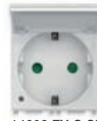
14208.FX.C.SL 2П+3 16 А, немецкий стандарт, с крышкой - 2 модуля. Глубина: 29,6 мм
